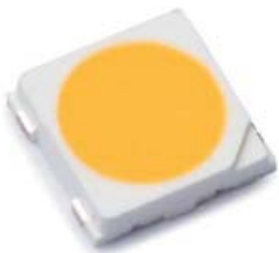
Рис. 1. Белый светодиод серии Luxeon 3535L компании Lumileds
