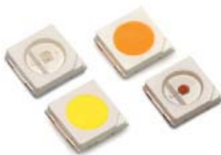
Рис. 2. Цветные светодиоды серии Luxeon 3535L Color компании Lumileds
