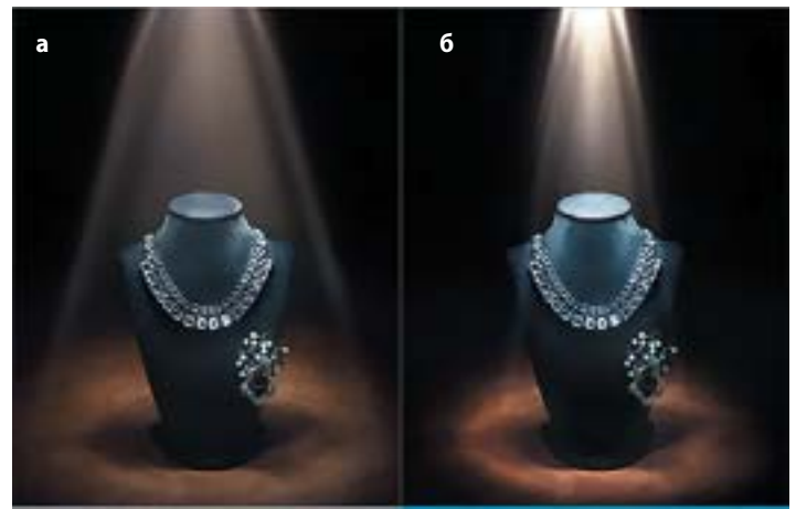
Рис. 8. Распространение света: а) от традиционного COB; б) от COB серии С с уменьшенным диаметром поверхности излучения (наглядно демонстрируется увеличение силы излучения в центре светового пучка у светодиодов от Samsung)
