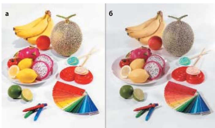
Рис. 3. Внешний вид объектов при освещении: а) светодиодными сборками Vivid Color COB от Samsung; б) газоразрядными лампами
