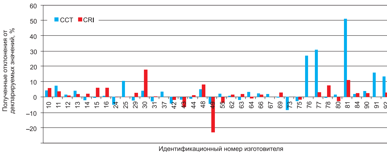
Рис. 6. Полученные различия между декларируемыми и фактически измеренными значениями коррелированной цветовой температуры (CCT) и индекса цветопередачи (CRI) для направленных светодиодных ламп
