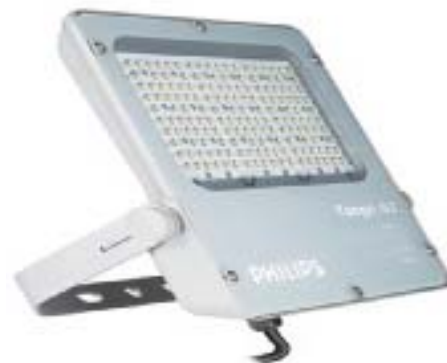
Рис. 4. Семейство Philips Tango G2 — линейка многоцелевых прожекторов заливающего типа, которые комплектуются светодиодными модулями, оптической системой, монтажной скобой, теплоотводом и драйвером
