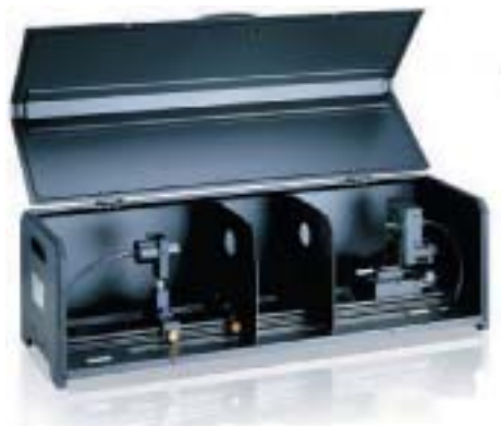
Рис. 6. Гониоспектро радиометр в компактном, защищенном от внешнего света корпусе (в данном приборе вместо детектора перемещается светодиод)
