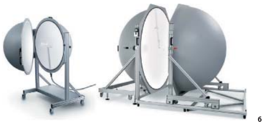
Рис. 2. Сферы: а) диаметром 1 м для измерения большинства отдельных светодиодов и модулей в обоих, 4π и 2π, рекомендованных геометриях; б) диаметром 2 м для больших светильников и продуктов твердотельного освещения
