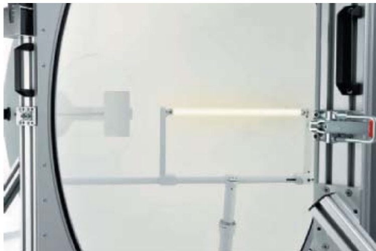
Рис. 4. Пример минимизации эффектов поглощения в ближней зоне (держатель линейной трубчатой лампы расположен максимально далеко от источника света и покрыт материалом с высоким коэффициентом отражения)
