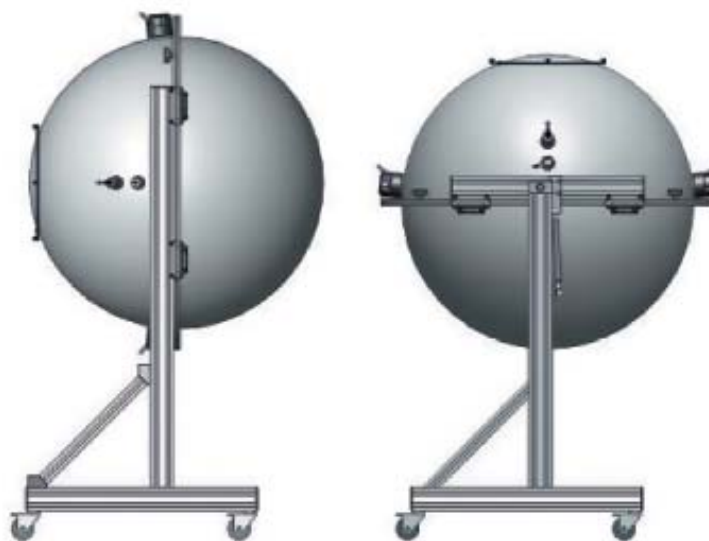
Рис. 5. Поворотная сфера диаметром 1 м (позиционно-чувствительные источники света могут быть измерены в их рабочем положении)
