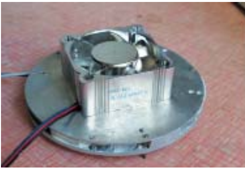
Рис. 12. Радиатор «ПК ИК Технологии» с активным охлаждением
