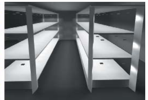
Рис. 17. Освещение стеллажа (результаты расчета E сп = 8080 лк, E мин /E сп = 0,63; PPF D = 149 мкмоль/с/м 2 , ФАР = 26 Вт/м 2 )
