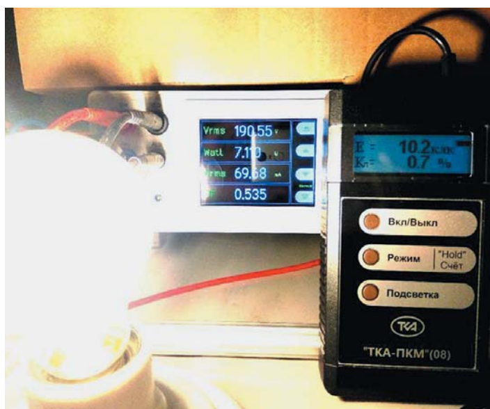
Рис. 11. Измерение K_{П} у типовой светодиодной лампы с импульсным драйвером
