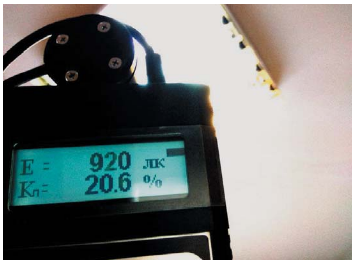
Рис. 3. Измерение K_{П} у светильника с люминесцентными ртутными лампами низкого давления
