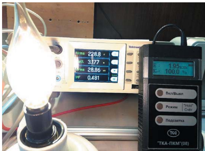
Рис. 7. Измерение K_{\Pi} у типовой светодиодной лампы с RC-драйвером
