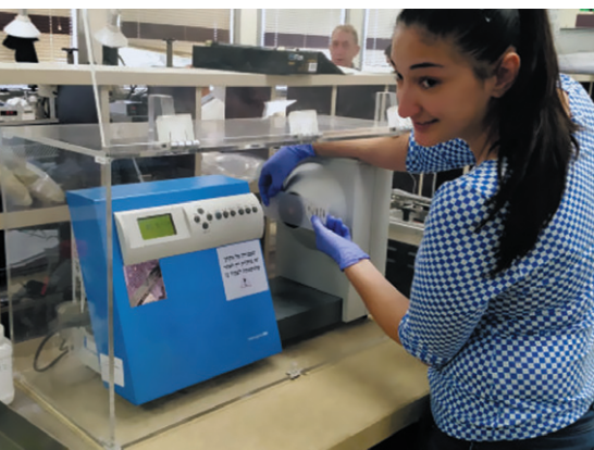
Рис. 1. Мутномер компании ВУК-Gardner широко используется для определения визуальных характеристик прозрачных материалов, например пленок, листов, пластмассовых изделий, линз или ветровых стекол. Мутномер может измерять коэффициент пропускания, мутность и прозрачность
