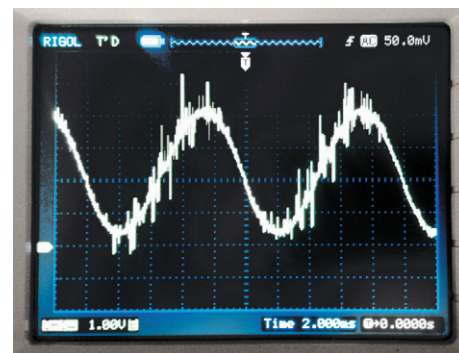
Рис. 12. Диаграмма напряжения «коллектор–эмиттер»
