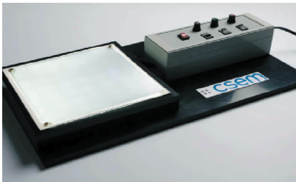
Рис. 4. Макет светодиодной панели с системой регулировки
