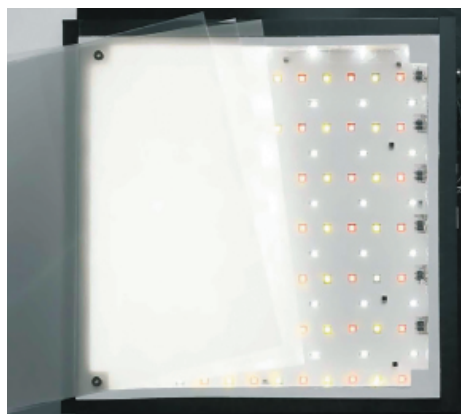
Рис. 3. Вид сверху на модуль (20×20 см) LASSIE-FP7 с многослойной оптической системой (слева) и без нее (справа). Многослойная система преобразует неоднородное распределение света, обусловленное точечными источниками света, в пространственно однородную излучающую поверхность
