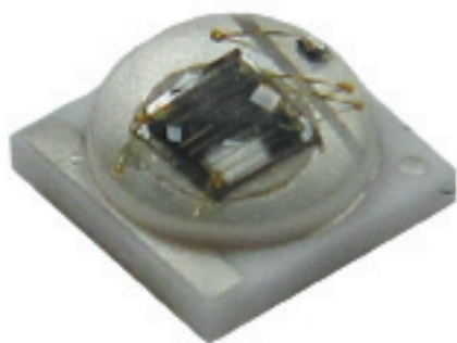
Рис. 4. Мощные УФ-светодиоды серии BC3535U-VNL1 компании SemiLEDs [8]
