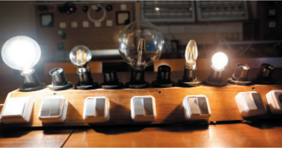
Рис. 2. ФСЛ разной мощности и разных объемов газовой смеси (слева направо: измеренная мощность 8,3; 6,4; 5,7; 4,3; 3,9 Вт. Часть ламп выключена)
