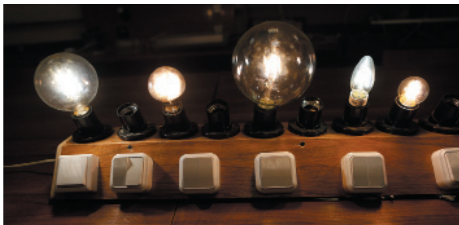
Рис. 1. ФСЛ разной мощности и разных объемов газовой смеси (слева направо: измеренная мощность 8,3; 6,4; 5,7; 4,3; 3,9 Вт. Лампы включены)
