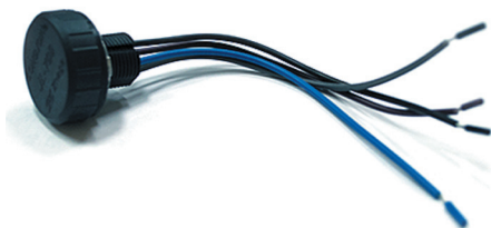
Рис. 25. Разъем ZHAGA JL-700 — новый разъем, предназначенный для светильников с управлением по DALI (DALI-2). Отличие от NEMA в том, что внутри светильника находится блок питания, способный передавать множество параметров о своем состоянии, в том числе и о потребляемой мощности
