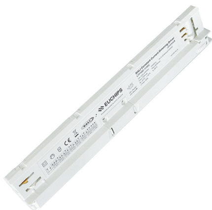
Рис. 10. Блок питания 220 В, устанавливаемый внутри шинпровода, от компании EUCHIPS LTP40D-1HMC, с возможностью управления по DALI
