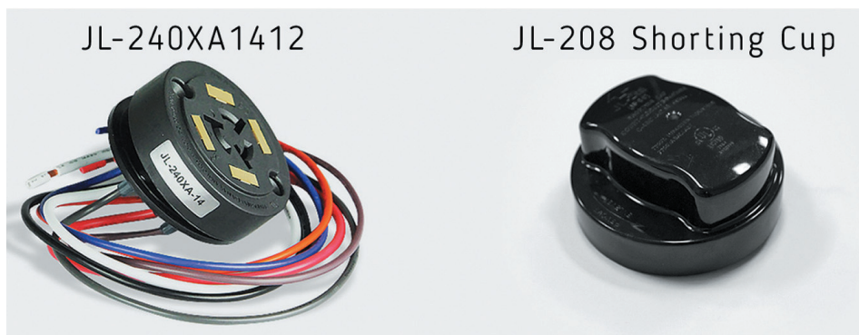
Рис. 24. Чтобы управлять светильником через радиоэфир, необходимо установить внешний контроллер и стандартный разъем для него — NEMA JL-240XA1412R7P-N1. Если же светильники собраны и их необходимо установить на объекте, а контроллеры все еще не готовы, в таком случае в разъем NEMA устанавливается заглушка JL-208 Shorting Cup
