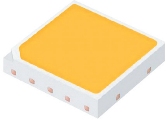
Рис. 19. Высокоэффективный популярный светодиод Cree LED JR5050B 6-V K Class в режиме мощности 2 Вт обеспечивает 200 лм/Вт, что позволяет в светильнике мощностью 50 Вт, с учетом всех потерь, добиться 170 лм/Вт
