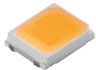
Рис. 22. Эффективный недорогой светодиод Cree LED серии JK2835 6V P Class. Отлично сочетается с оптикой VIMIN и заменяет популярные на сегодня диоды 3030 6V благодаря улучшенным характеристикам: 1 — защита от деградации серы и других газов; 2 — сложная форма токоведущей проволоки для защиты от механических воздействий и естественного изменения размеров диода при термоциклировании -40...+65^{\circ}\text{C}
