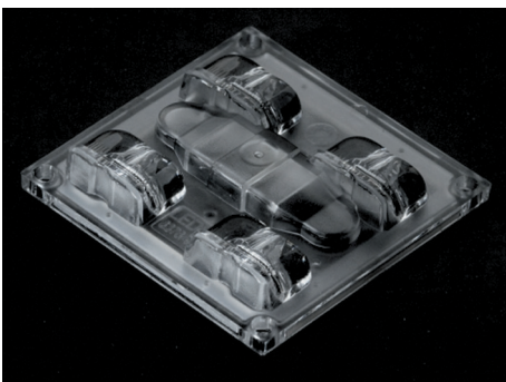
Рис. 15. Компактная линза LEDiL CS16515_SITARA-2X2-T2 (с силиконовым уплотнителем в комплекте) очень популярна для боллардов, так как позволяет сделать защиту IP65 на уровне самой линзы, без защитного стекла
