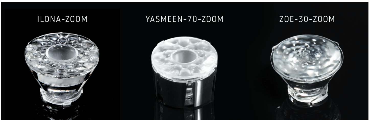
Рис. 8. Симметричные линзы с возможностью изменения угла (переменным фокусным расстоянием) в широком диапазоне 10–50° за счет отдаления сублинзы от основной линзы также становятся очень популярны; представлены варианты ILONA-ZOOM, YASMEEN-70-ZOOM и ZOE-30-ZOOM
