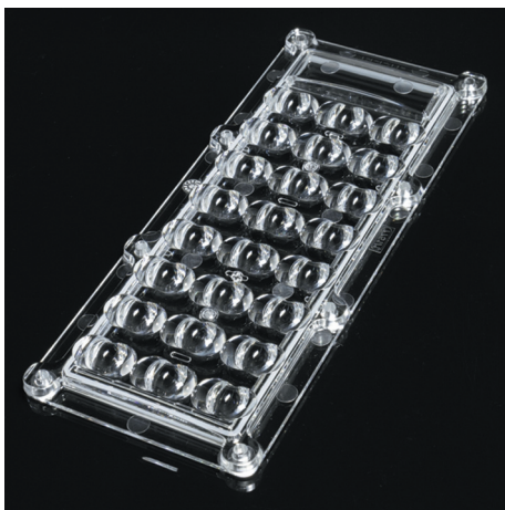
Рис. 18. Линза LEDiL CS17760_STRADA-IP-24-DWC-PC (с уплотнителем в комплекте для IP65), состоит из 24 ячеек, рассчитанных под светодиод 5050, заменяя тем самым сразу две самые популярные линзы STRADA-IP-2X6-DWC. При этом размер и отверстия для крепления линзы полностью совпадают с семейством линз IP-2x6, что позволяет уменьшить размер светильника
