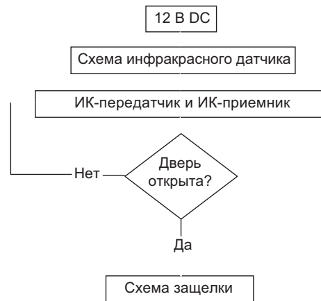
Рис. 3. Схема управления инфракрасными датчиками передатчика и приемника
