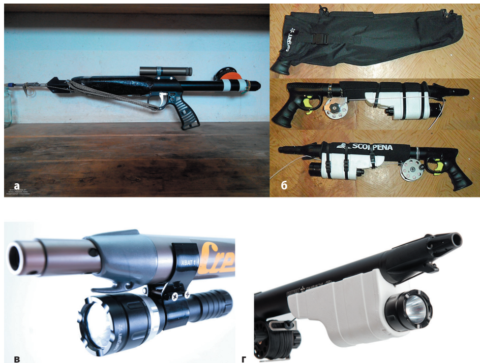
Рис. 14. Подводные ружья с СД подводными фонарями: а) «Оса-600» с СД-фонарем HunterOroLight-3; б) комплект для подводной охоты с ружьем «Сарган» и СД-фонарем; в) крепление СД-фонаря Patriot VH-fl08 на подводном ружье «Сарган»; г) универсальное крепление СД подводного фонаря на ружье «Сарган»
